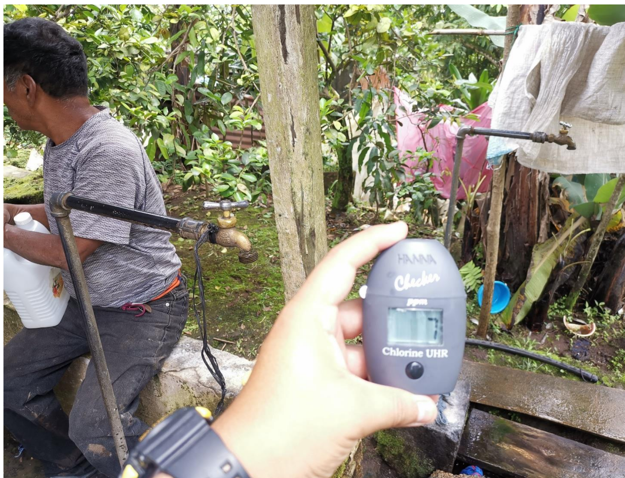
Fotografía 8: Medición de cloro residual en el sistema de agua del Caserío Chirijalimá, aldea Palacal.
