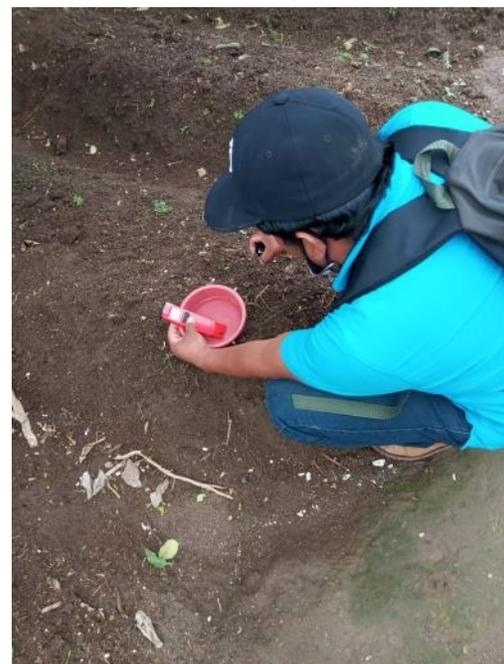
Ilustración 11: Medición de potencial de Hidrógeno
