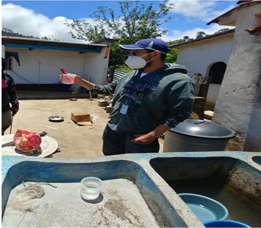
Ilustración 16. Medición del potencial de hidrogeno en viviendas de la comunidad
