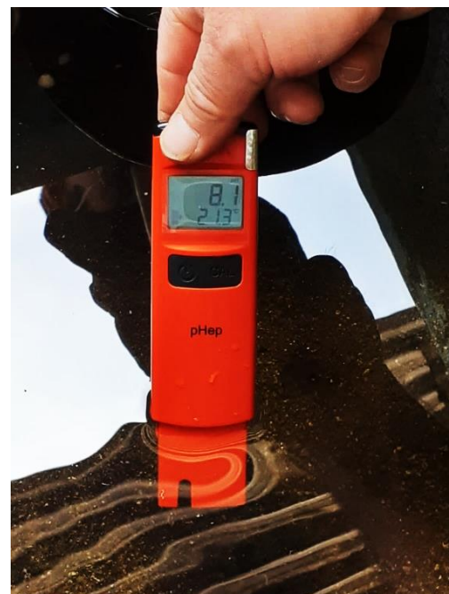
Ilustración 7: Medición de potencial de Hidrógeno
