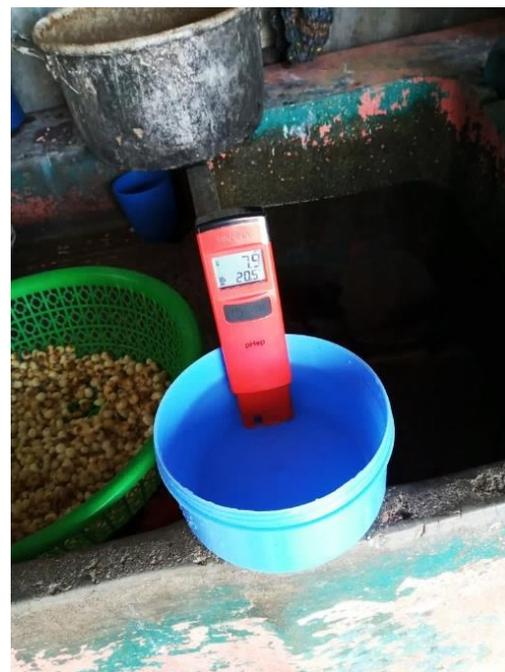
Ilustración 11: Medición de potencial de Hidrógeno
