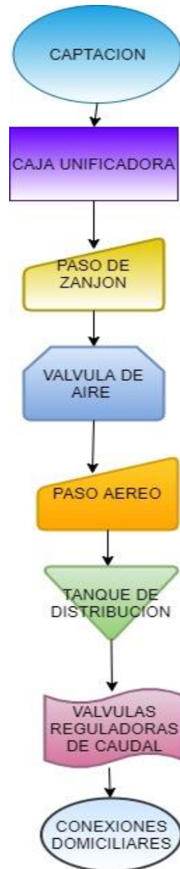
Ilustración 2. Diagrama de flujo del proceso del sistema de agua evaluado.
