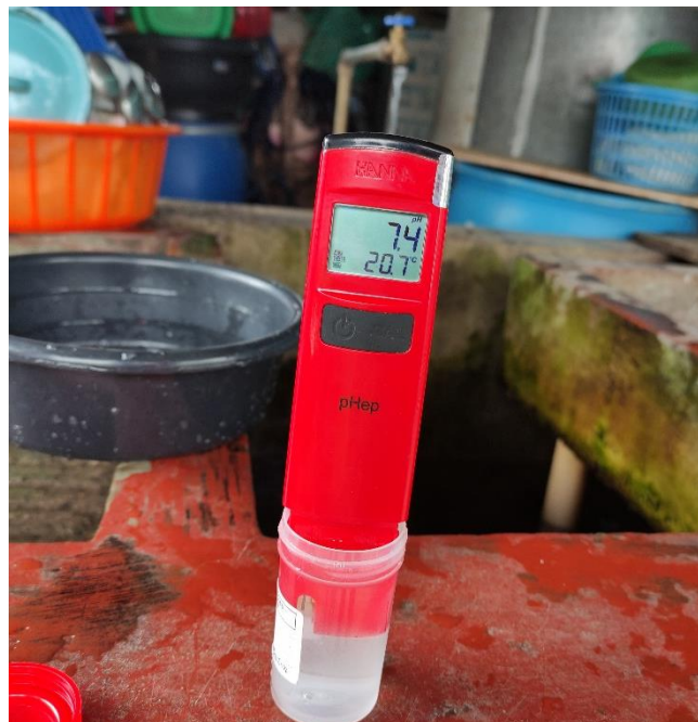
Ilustración 16: Medición de potencial de Hidrógeno
