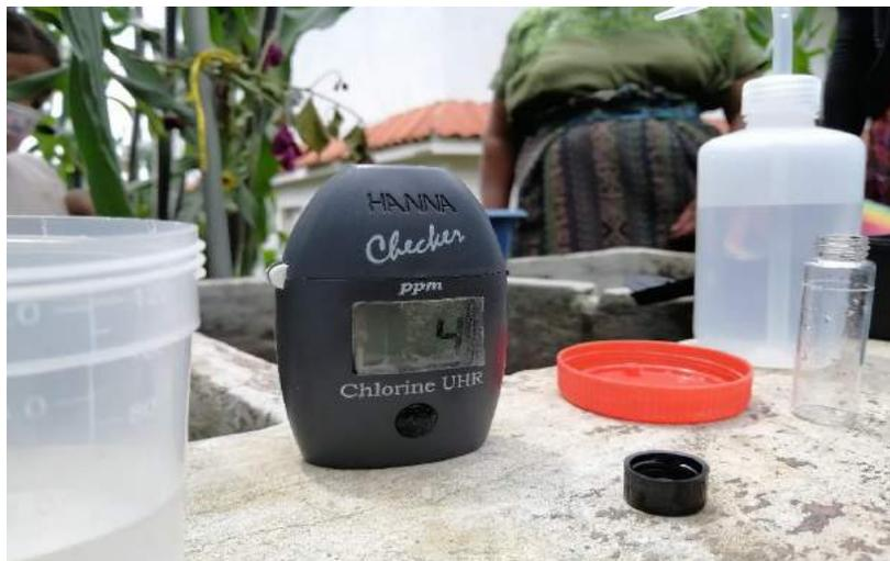
Fotografía 14 monitoreo de cloro residual después de la instalación del clorador artesanal
