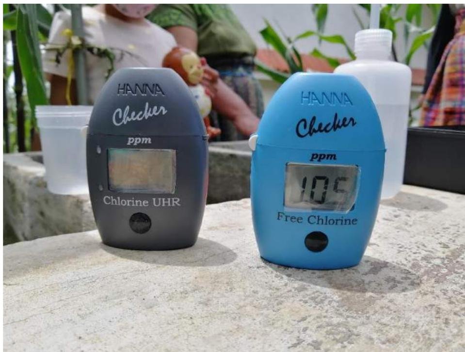
*Fotografía 9 Monitoreo de cloro residual, después de la instalación del clorador artesanal*
