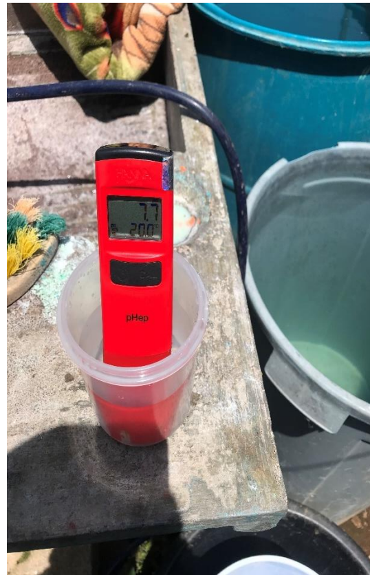
Ilustración 12. Medición de pH en viviendas del sistema
