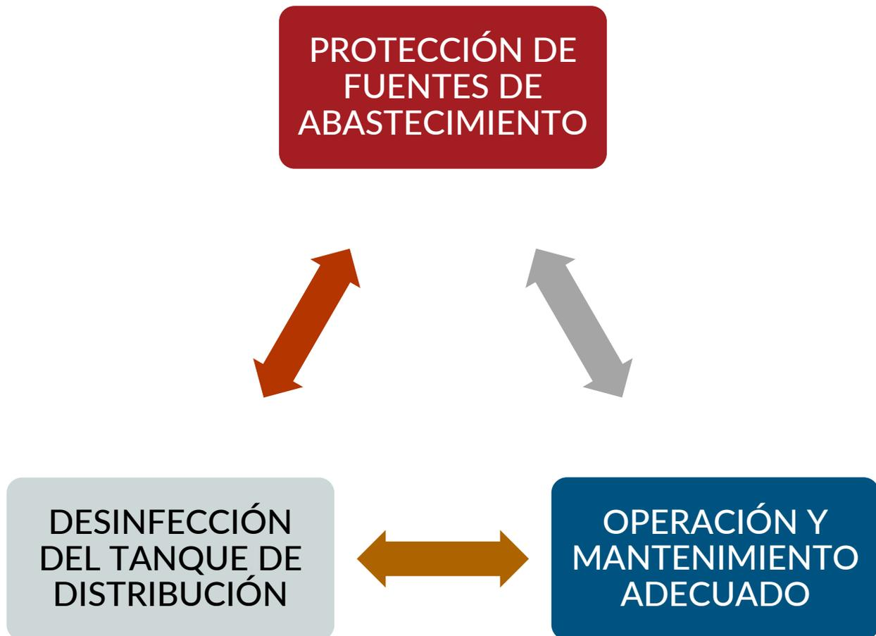
Ilustración 14: Control de la calidad del agua (ciclo)
