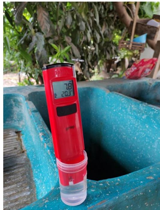
Ilustración 13: Medición de potencial de Hidrógeno
