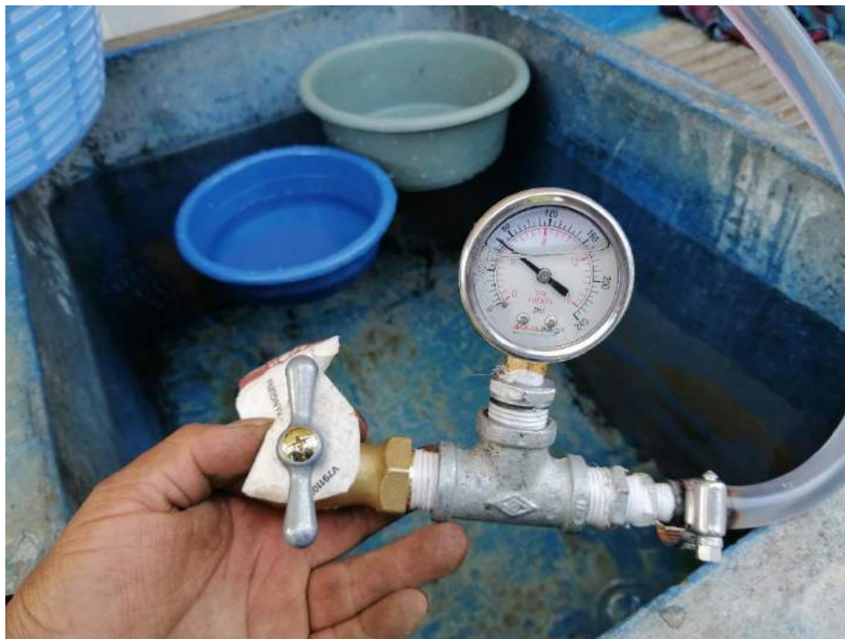
Fotografía 12 Medición de presión en chorros
