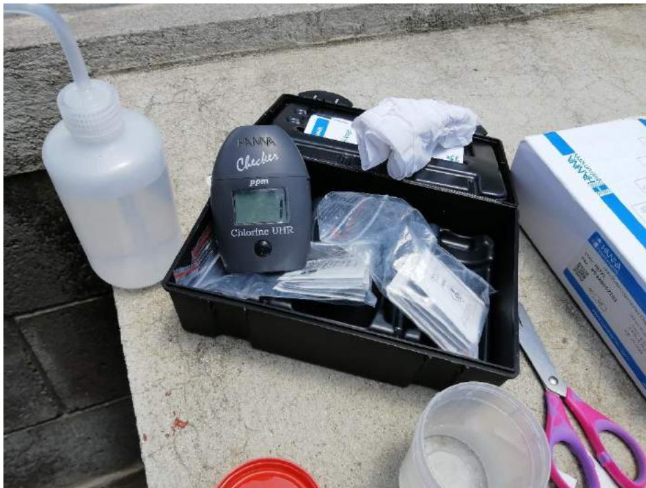
Fotografía 10 Monitoreo de cloro después de la cloración
