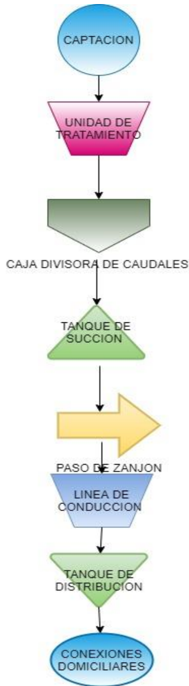
Ilustración 2. Diagrama de flujo del proceso del sistema de agua evaluado.
