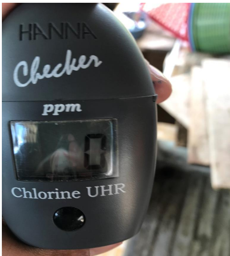
Ilustración 12. Medición de cloro en visitas domiciliarias a usuarios del sistema
