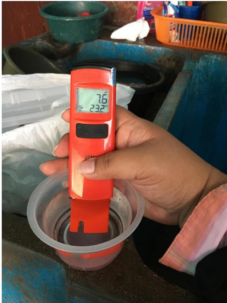
*Ilustración 14: Medición de pH.*
