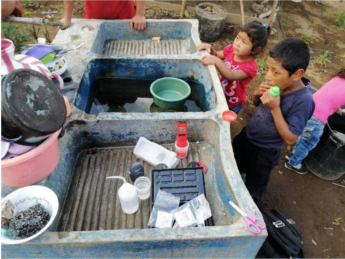
Fotografía 11 Medición de cloro residual y potencial de hidrogeno
