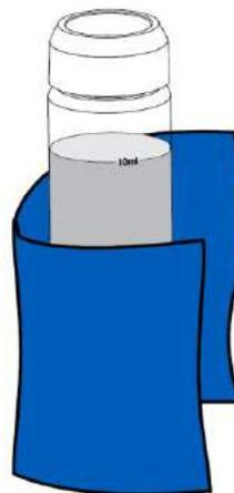
3. Si agita la cubeta puede generar burbujas en la muestra, causando lecturas más altas. Para obtener mediciones precisas, elimine tales burbujas haciendo girar el vial o tocándolo suavemente.
