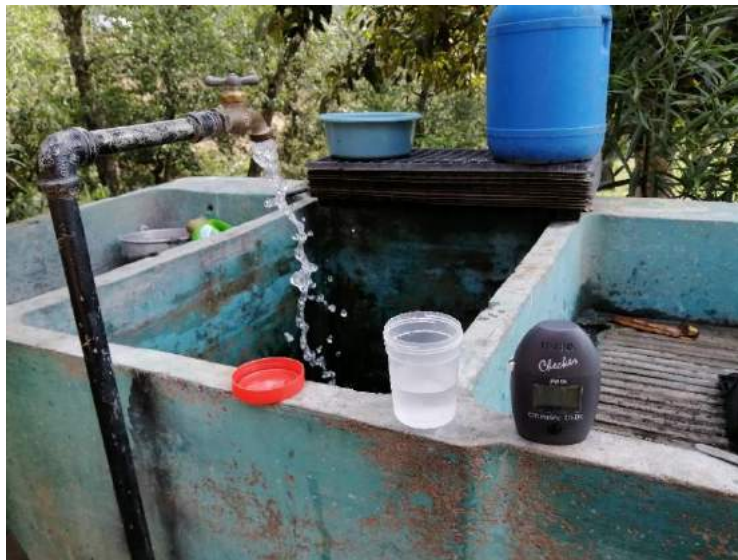
Fotografía 4 Medición de potencial de hidrogeno y cloro residual
