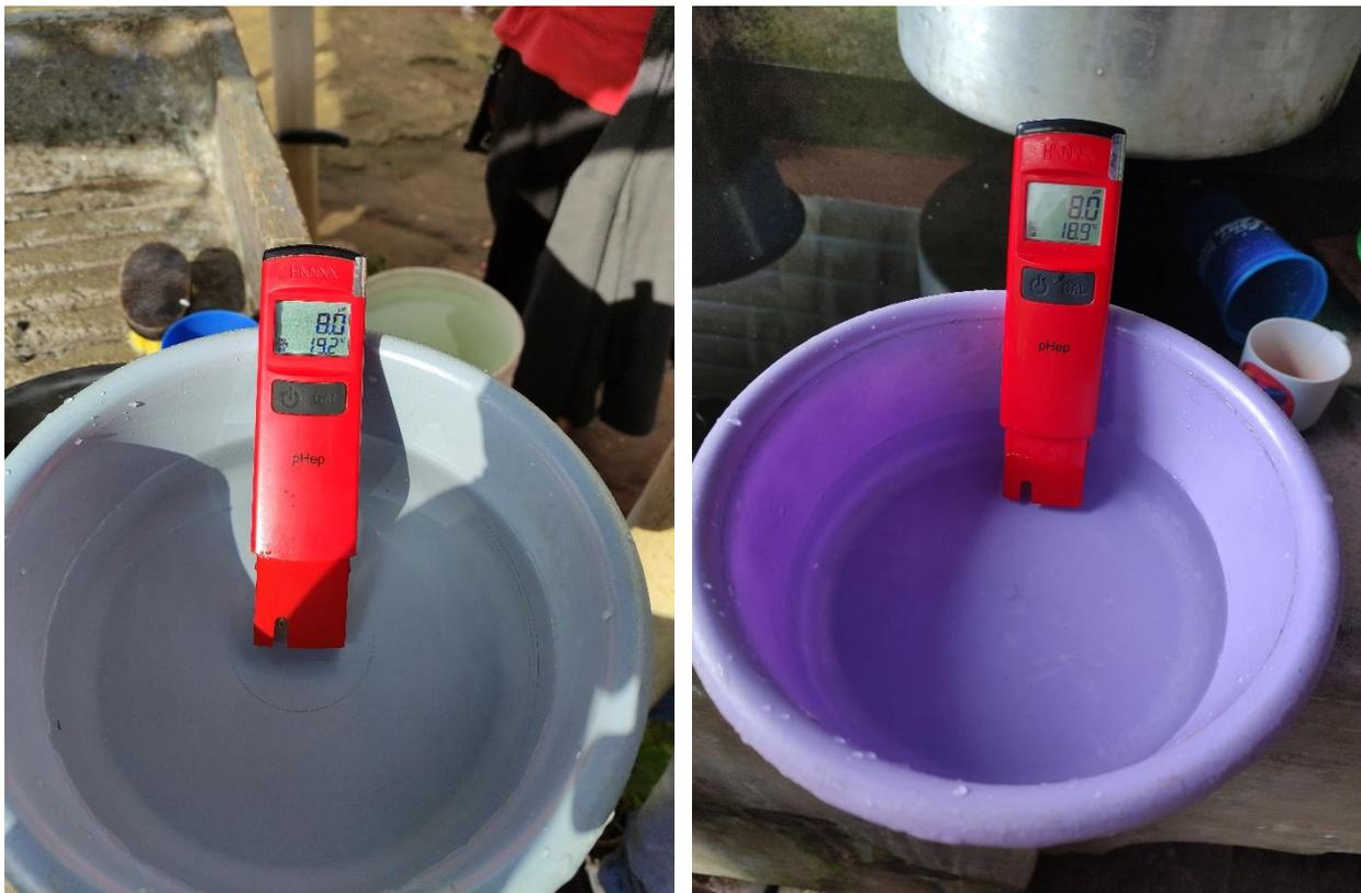
Ilustración 11: Medición de potencial de Hidrógeno
