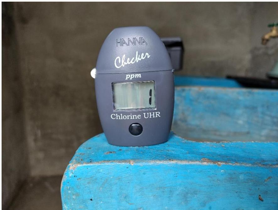
Ilustración 14: Medición de cloro residual
