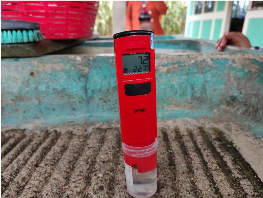
Ilustración 15: Medición de potencial de Hidrógeno
