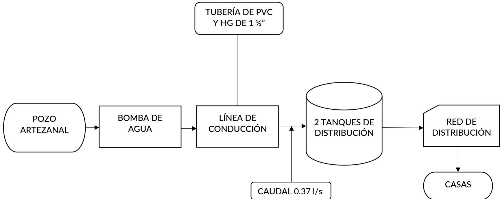
Ilustración 2: Diagrama de flujo del proceso del sistema de agua evaluado
