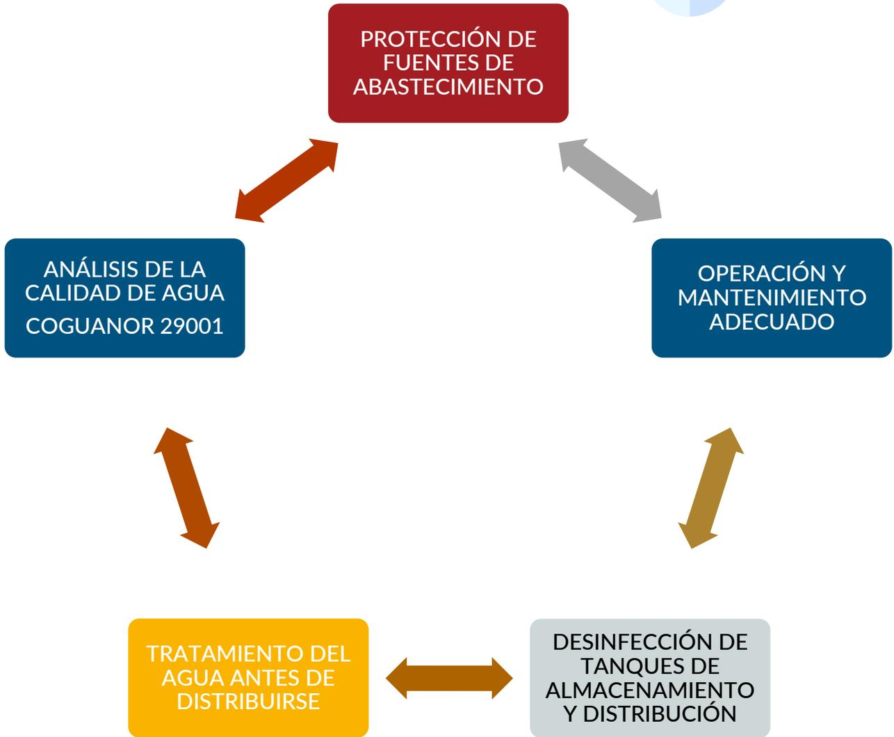
Ilustración 11: Control de la calidad del agua (ciclo)
