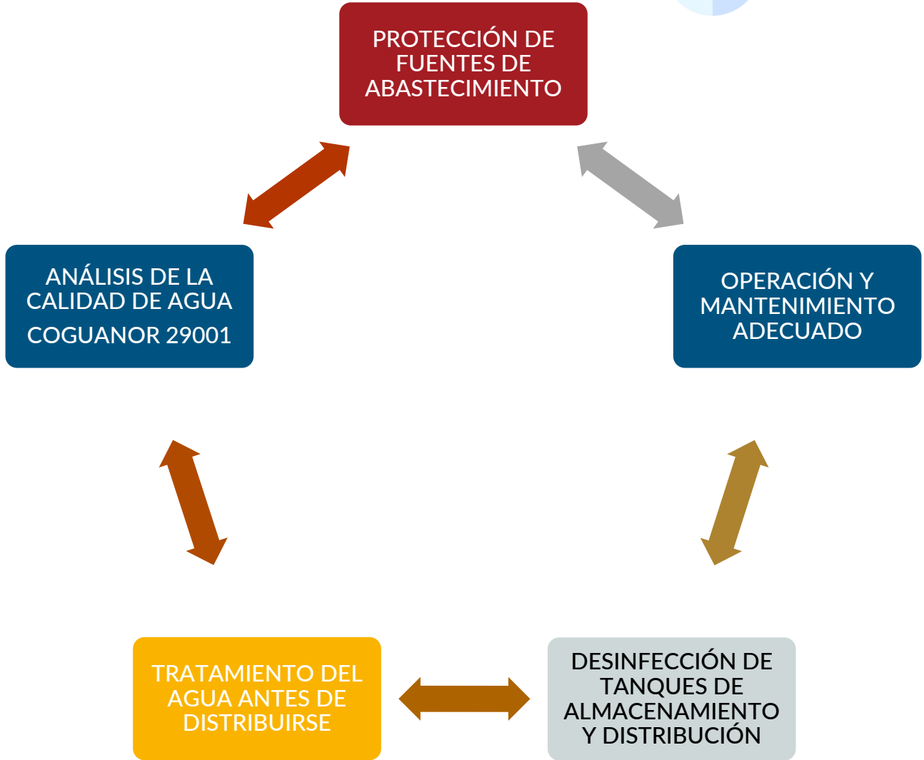
Ilustración 16: Control de la calidad del agua (ciclo)
