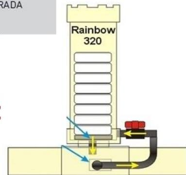
Realizar inspecciones semanales para asegurarse de que tenga pastillas y que estén en contacto con el agua.
