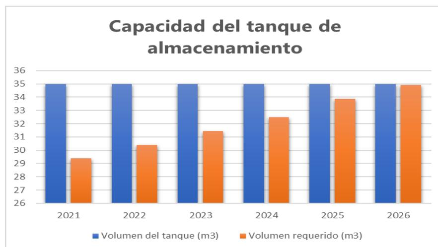
Ilustración 11. Capacidad del tanque de almacenamiento.
