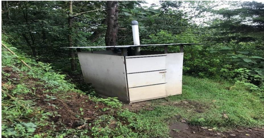
*Ilustración 6. Descarga final de excretas mediante letrinas ventiladas.*
