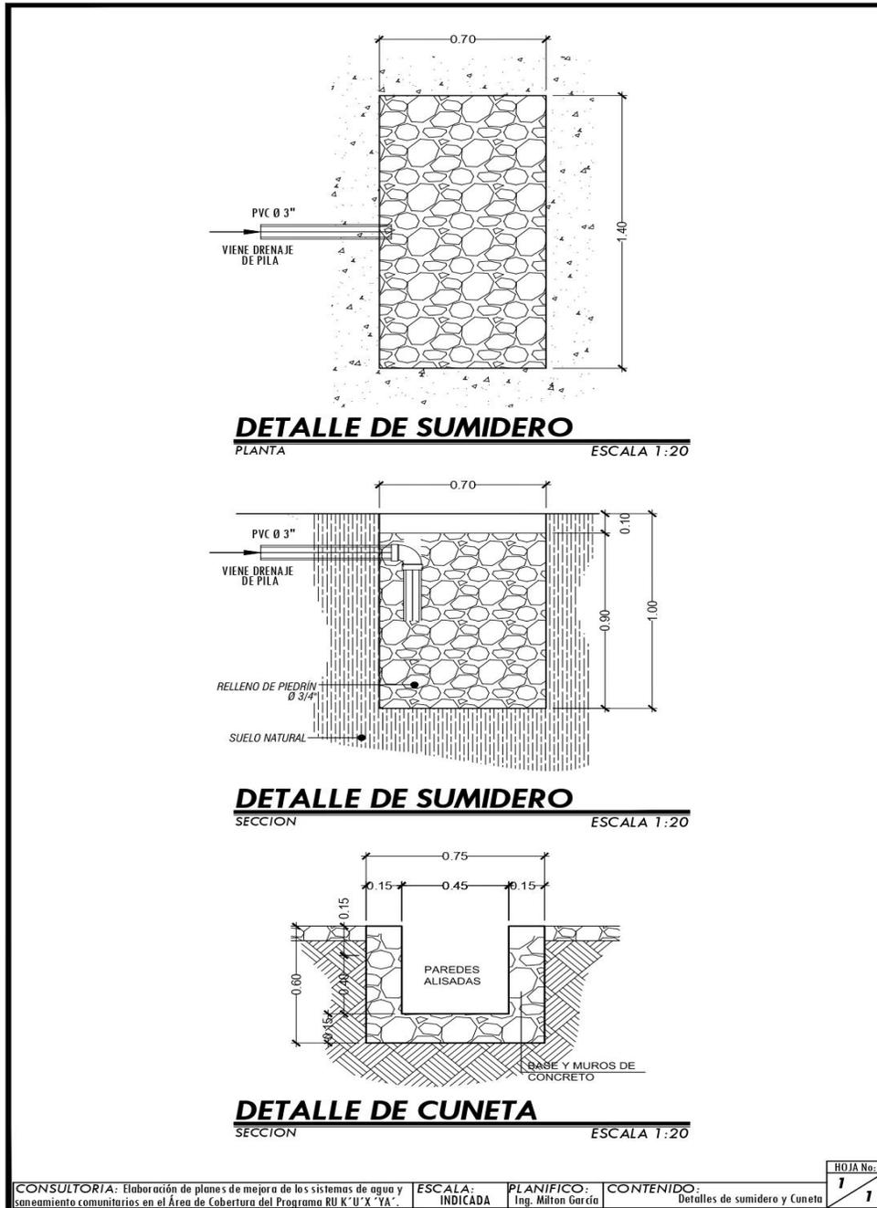
Ilustración 19. Detalles de pozo sumidero.
