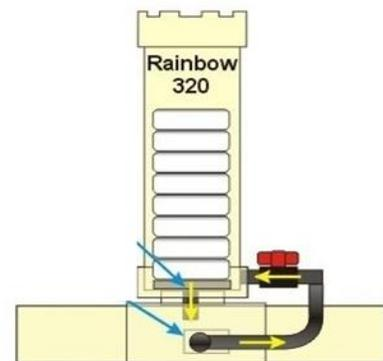
Ilustración 29. Manual de cloración con pastilla.
