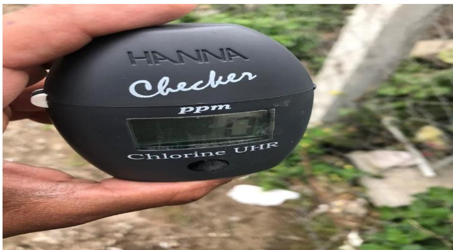
Ilustración 14. Medición de cloro residual en visitas a usuarios del sistema.
