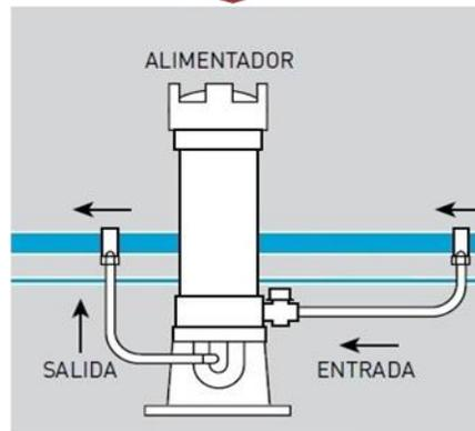
Mantener como máximo 5 pastillas en el dispositivo de cloración, para reducir las posibilidades de compresión de pastillas.
