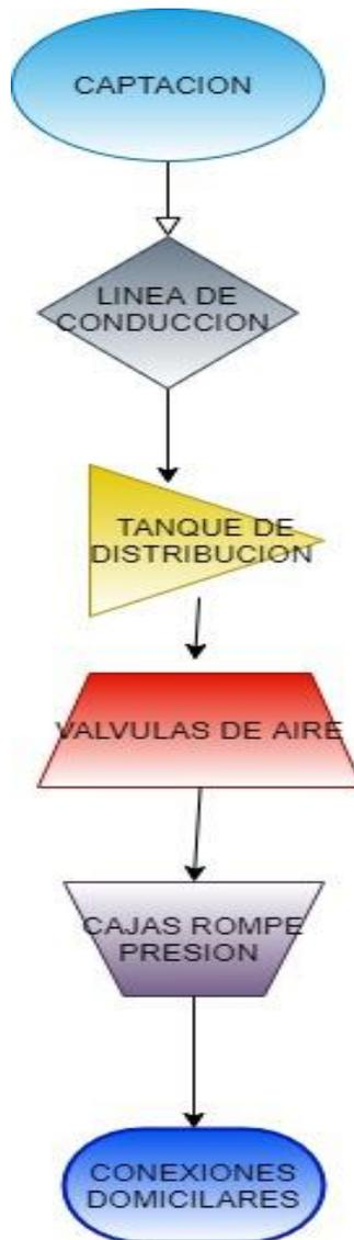
Ilustración 2. Diagrama de flujo del sistema de agua evaluado.
