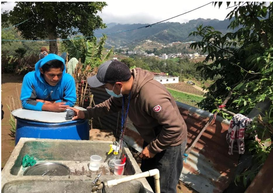
Ilustración 10. Medición de cloro en visitas domiciliarias a usuarios del sistema.
