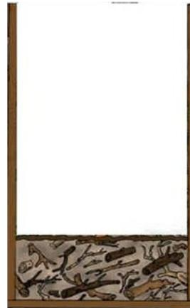
Introducir una masa de al menos 50 cm de materiales secos y húmedos mezclados o en capas, para iniciar el proceso.
