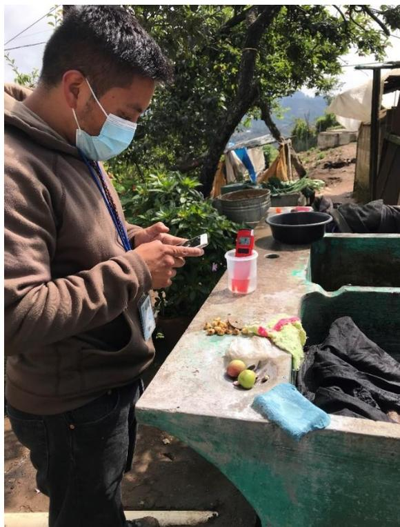
Ilustración 11. Medición de pH en viviendas
