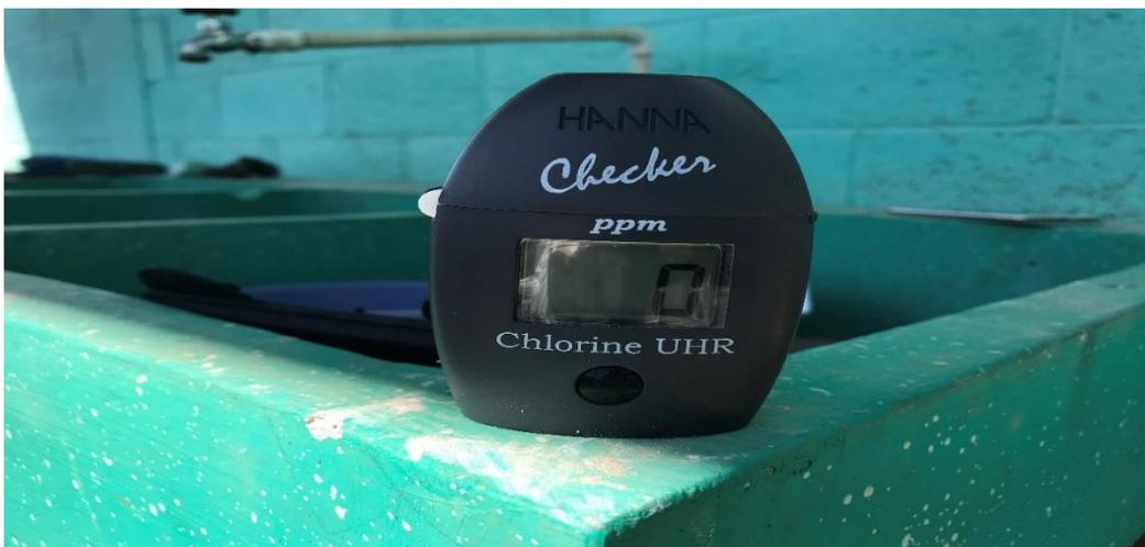
*Ilustración 11. Medición de cloro en visitas domiciliarias a usuarios del sistema*
