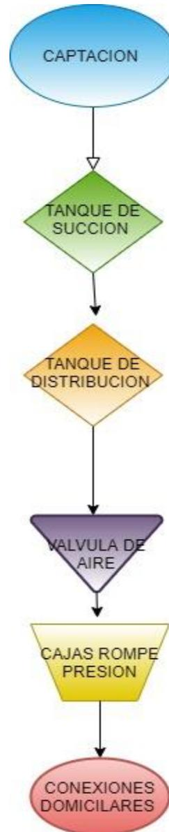
Ilustración 2. Diagrama de flujo del proceso del sistema de agua evaluado.
