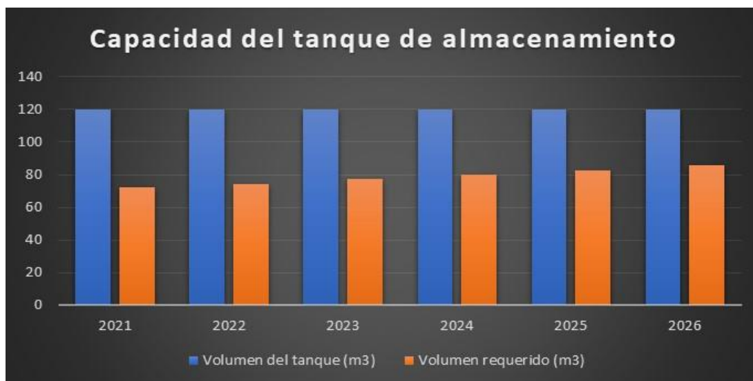
Ilustración 10. Capacidad del tanque de almacenamiento
