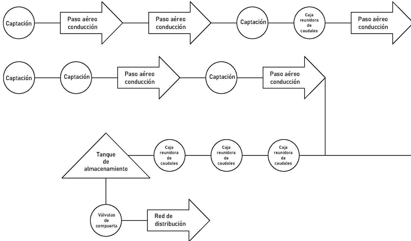
Ilustración 4. Diagrama de flujo del proceso del sistema de agua evaluado
