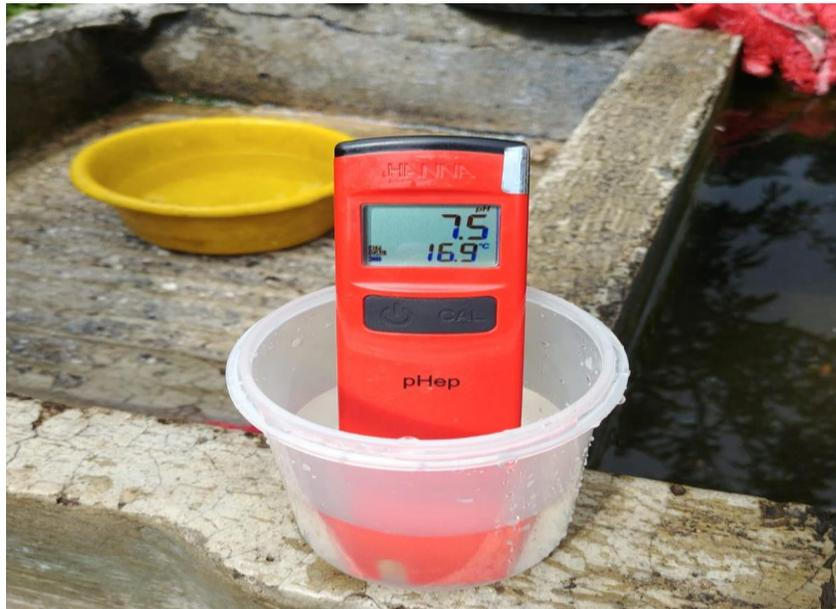
*Ilustración 17. Medición del potencial de hidrogeno en viviendas de la comunidad*
