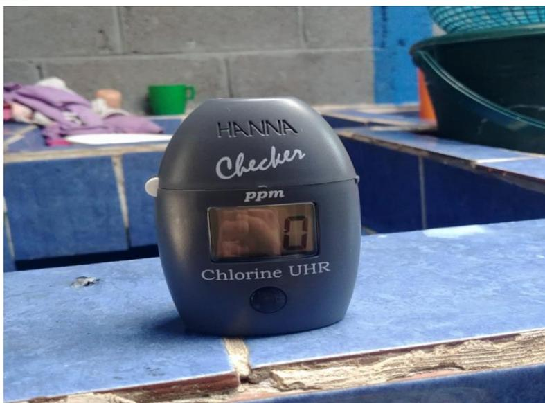
Ilustración 16. Medición de cloro residual en viviendas de la comunidad
