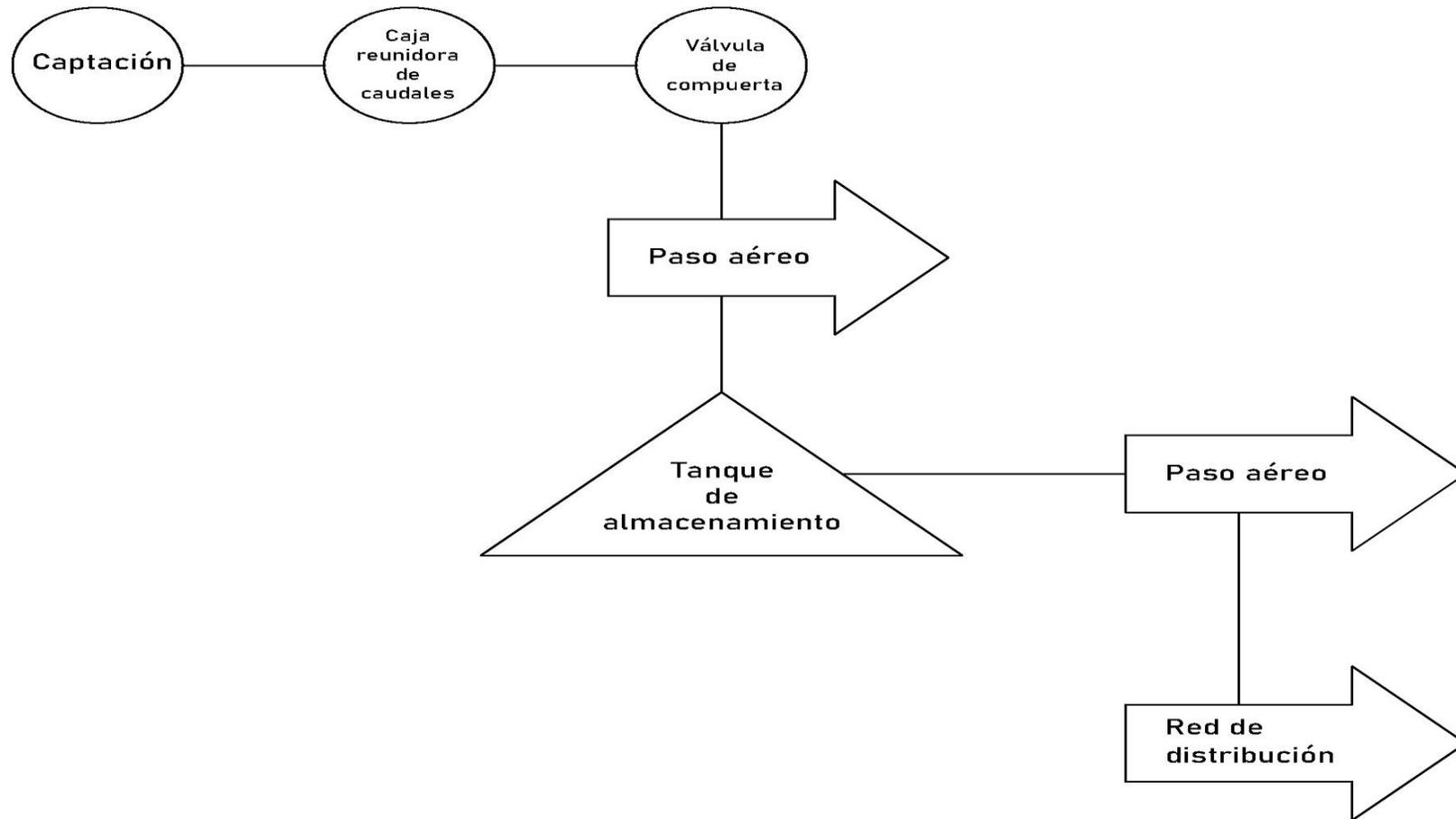
Ilustración 4. Diagrama de flujo del proceso del sistema de agua evaluado
