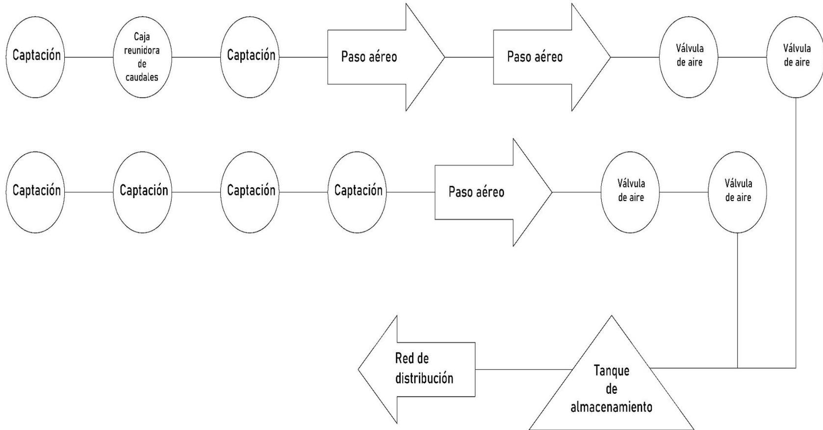
Ilustración 4. Diagrama de flujo del proceso del sistema de agua evaluado
