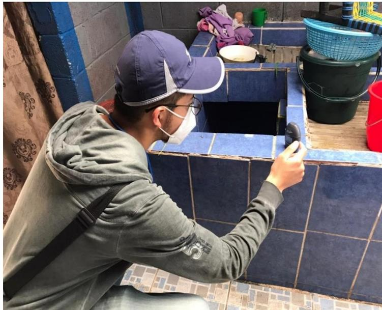
Ilustración 17. Medición de cloro residual en viviendas de la comunidad
