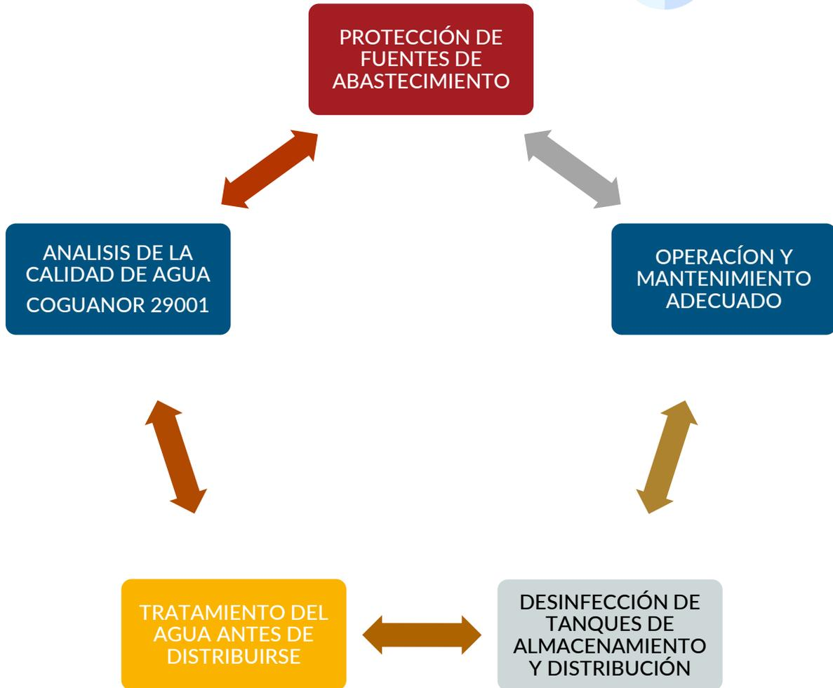
Ilustración 18. Diagrama control de la calidad del agua
