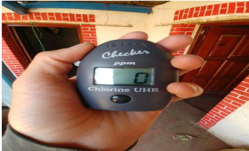
Ilustración 16. Medición de cloro residual en viviendas de la comunidad
