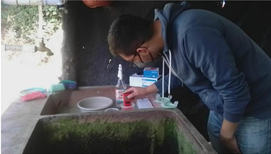
*Ilustración 17. Medición del potencial de hidrogeno en viviendas de la comunidad*
