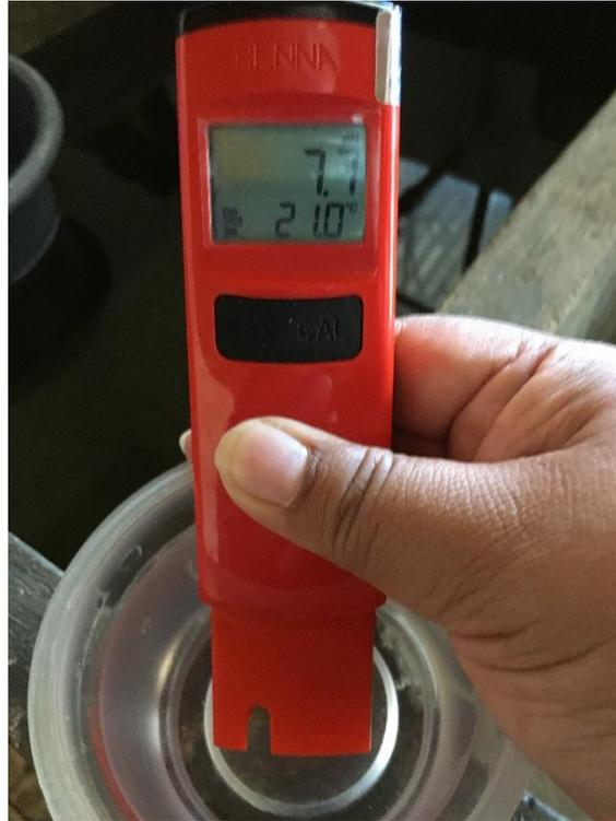
Ilustración 8: Medición de pH.
