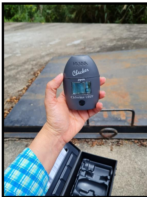
Ilustración 10. Medición de cloro residual tanque de distribución de sistema Nacimientos Fuente: Elaboración propia
