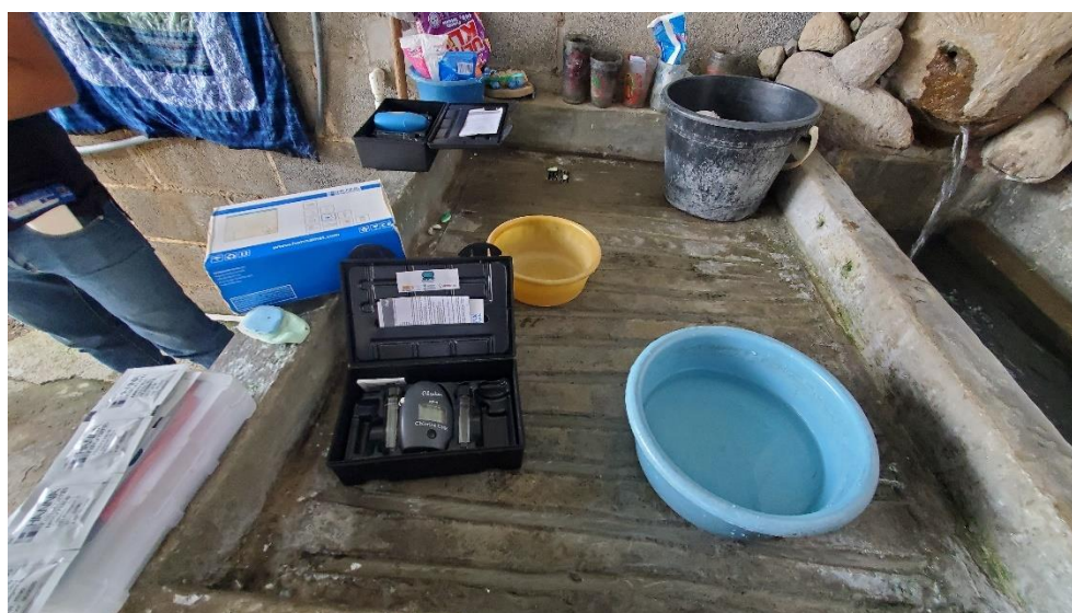
Fotografía 29. Medición cloro residual en vivienda
