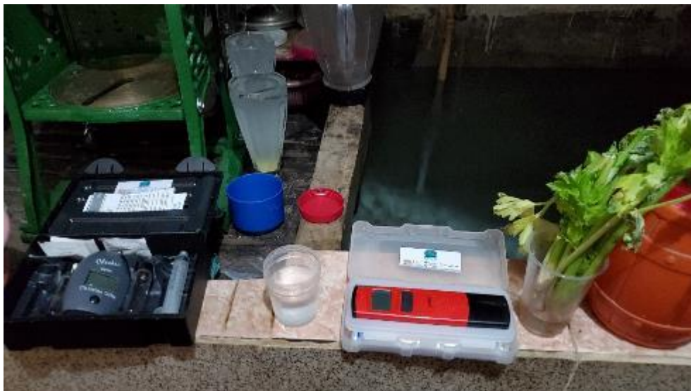
Fotografía 58. Medición cloro residual en vivienda
