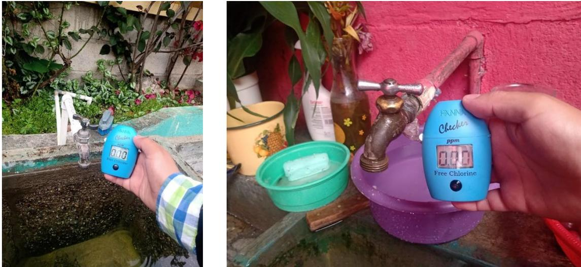
En la fotografía 16 se puede observar que las viviendas incumplen la dosis mínima de cloro residual fijada por la norma coguanor NTG 290001.
