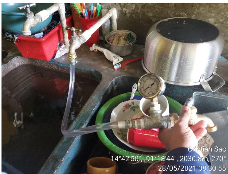
Fotografía 22. Medición de presión en viviendas.
