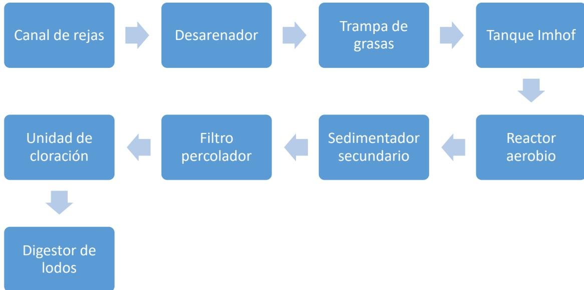
Ilustración 12. Esquema de tratamiento aerobio
